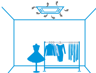
Distribuzione dell'aria con filtro sporco
